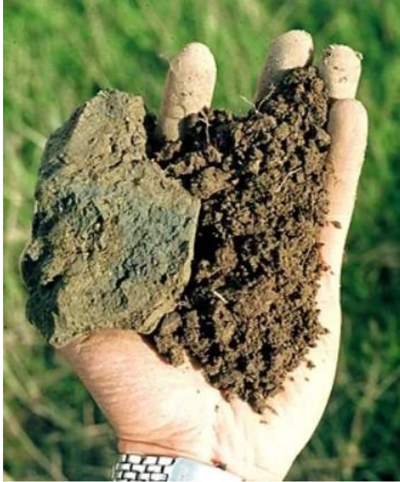
Дијаграм 2 Сино/сиво или зелено шаренило (лево) во почвата е показател за слаба дренажа
