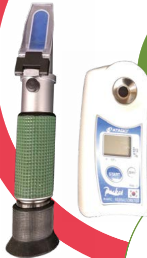
Слика 4 – Оптички рефрактометар (лево) и дигитален рефрактометар (десно) Извор: Dr. Macarena Farcuh, University of Maryland
